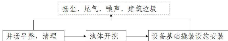
图 3.3-1 钻前工程施工过程及产污环节示意图
