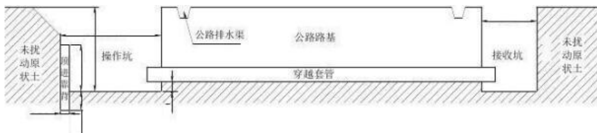
图 3.3-5 穿越道路施工作业示意图
