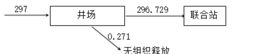
图 3.3-2 拟建工程井场硫平衡图 单位：kg/a
