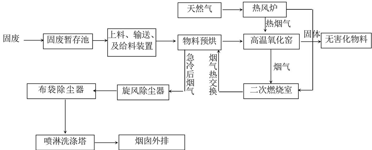
图 3.2-3 钻井聚磺体系岩屑固废处理工艺流程图
