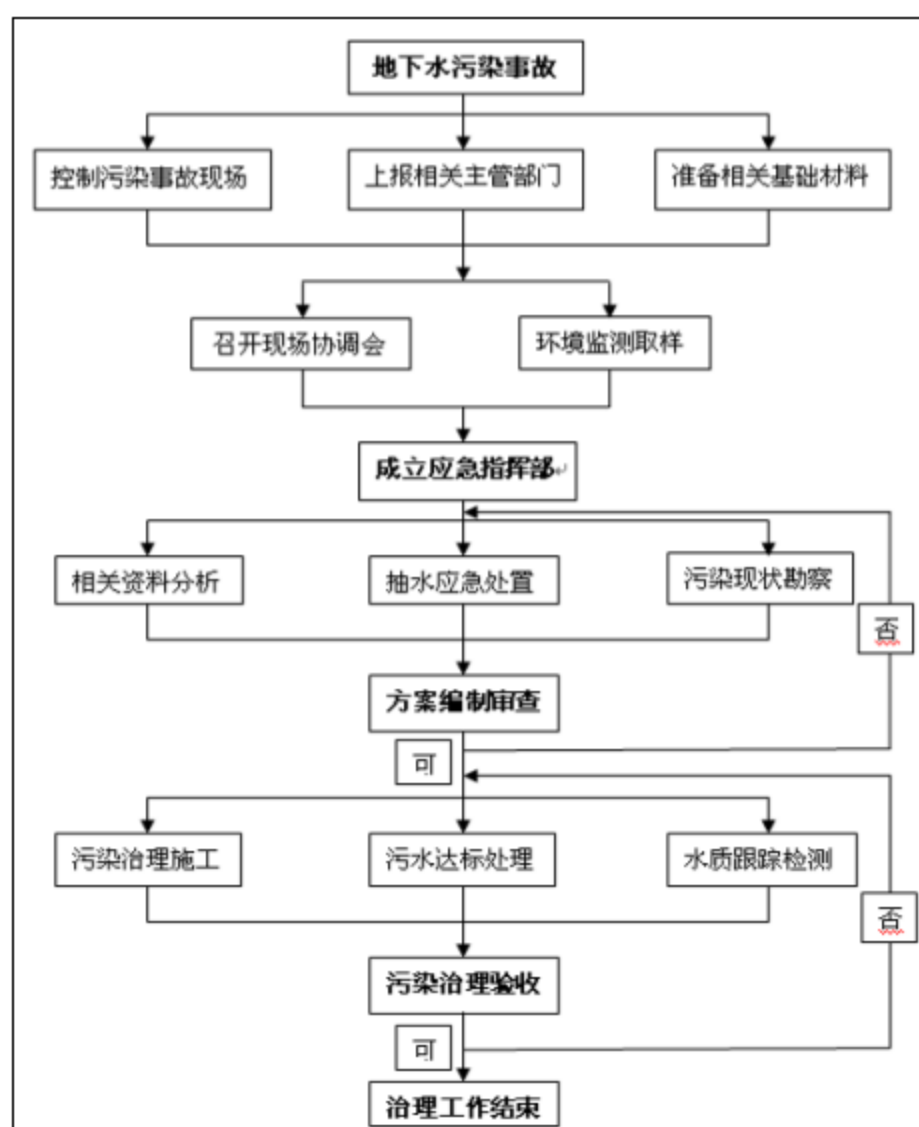
图 6.2-4 污染应急治理程序框图
